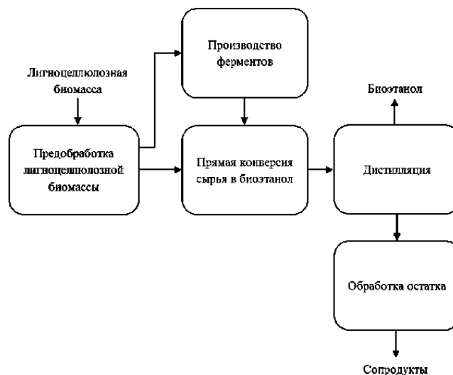
Рисунок 8 – Принципиальная схема SSCF-технологии получения биоэтанола из лигноцеллюлозного сырья [46]
