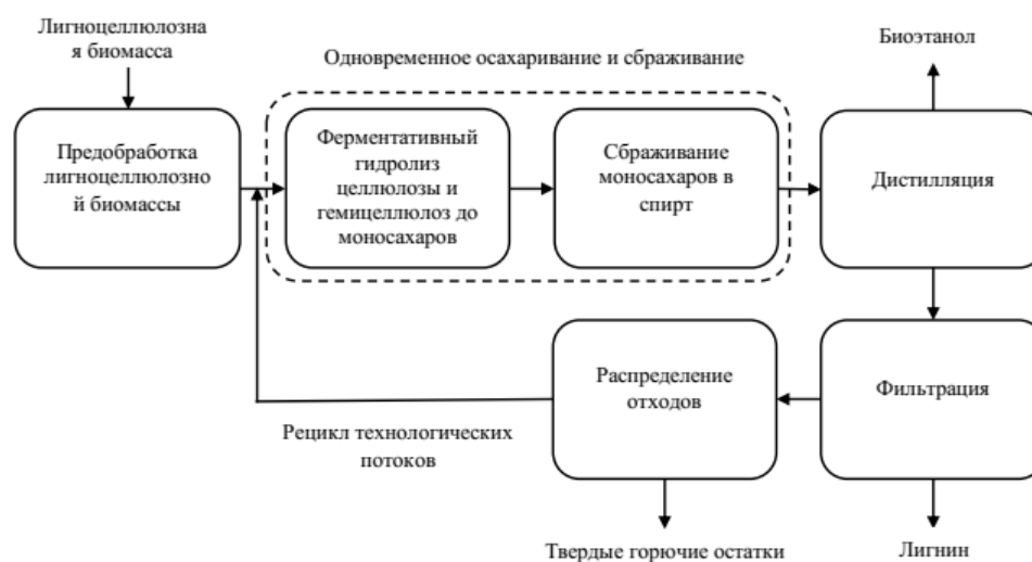
Рисунок 7 – Принципиальная схема SSF-технологии получения биоэтанола из лигноцеллюлозного сырья [36].
