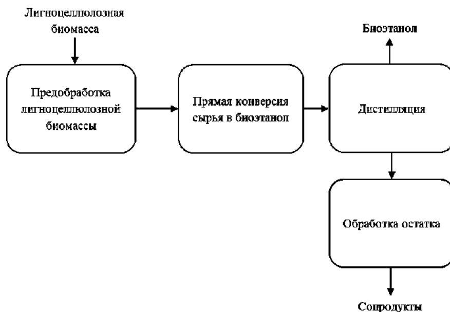
Рисунок 9 – Принципиальная схема СВР-технологии получения биоэтанола из лигноцеллюлозного сырья [46]
