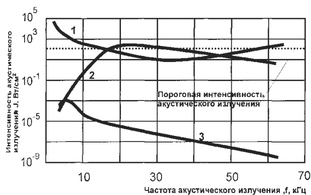
Рисунок 1 - Зависимость интенсивности акустического излучения диспергаторов от его частоты: 1- РПАА, 2- статический ультразвуковой излучатель УЗДН, 3-РПА
