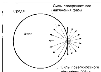
а – распределение сил поверхностного натяжения
